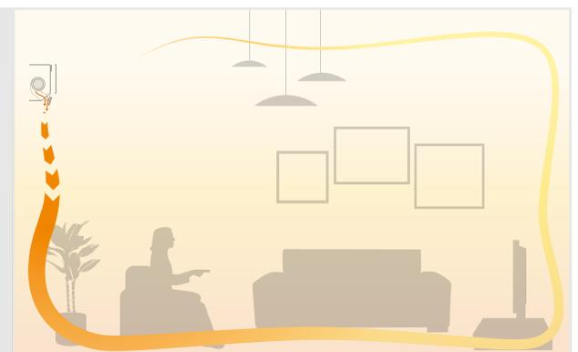
Der Coanda-Effekt erzeugt zwei unterschiedliche Luftstrommuster, je nachdem, ob das Stylish im Kühl- oder Heizbetrieb ist. Die oberen beiden Bilder zeigen den Coanda-Effekt im Kühlmodus (Deckenluftstrom), die unteren Bilder hingegen stellen den Coanda-Effekt im Heizmodus (vertikaler Luftstrom) dar.
